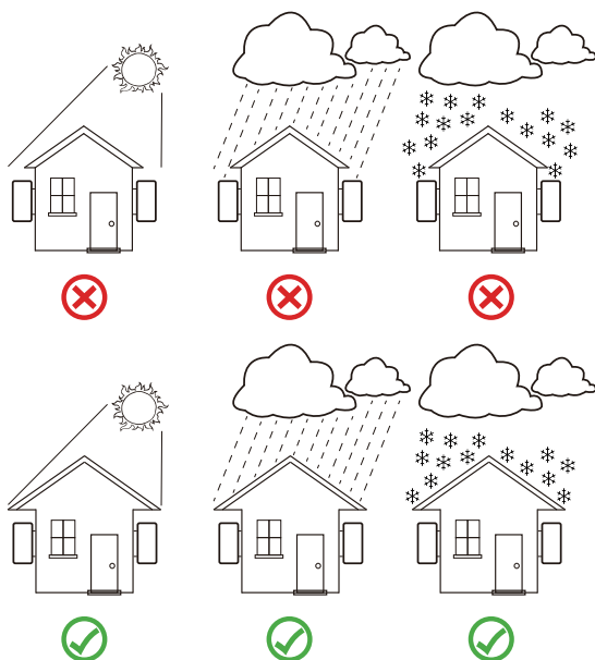
Rys. 4.1 Rekomendowane miejsce instalacji
